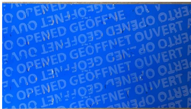
Abbildung 3: Siegelband nach Manipulation
